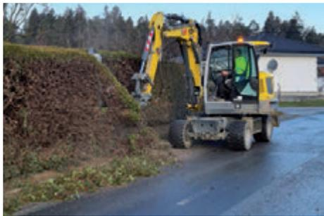
em Freischneide-Aufbaugerät der Lichttraum freigeschnitten. Der wochenlange Einsatz hat sich gelohnt und wurde vielerseits gelobt – Freischnitt des Überwuchses bis zu einer Höhe von 5 bis 6 Meter und seitlich Auswuchs innerhalb eines Meters zur Fahrbahn wurden aus Sicherheitsgründen zurückgeschnitten und das Grobmaterial mit einem Forstanhänger abgeführt. Die Straßenabspernungen und Nachbearbeitungen wurde durch Bauhofmitarbeiter begleitet.
