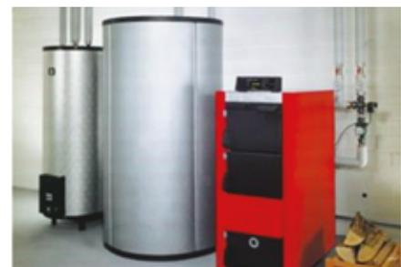
Stückholzkessel sollten auf alle Fälle mit einem Pufferspeicher (70 - 100 Liter pro kW Kesselleistung) ausgerüstet werden. Dadurch werden ein höherer Jahresnutzungsgrad, ein größerer Heizkomfort, niedrigere Emissionen und ein geringerer Brennstoffverbrauch erreicht. Um einen komfortablen Sommerbetrieb zu erreichen, ist die Kombination mit einer solarthermischen Anlage sehr empfehlenswert.
